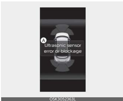
A: Ultrasonic sensor error or blockage
